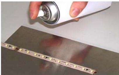
Für ESD sicheres Lackieren der Module empfehlen wir die Verwendung von Sprühlack. Sollten Sie dennoch den Lack mit dem Pinsel auftragen (nicht empfohlen), verwenden Sie keine Pinsel mit Kunststofffasern.
