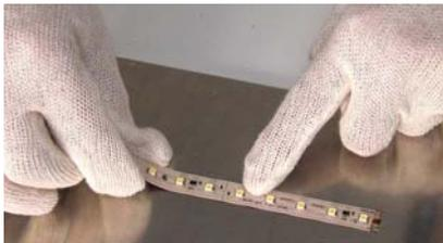
Tragen Sie zusätzlich zur Erdung bei der Verarbeitung der Module Baumwollhandschuhe. Dies gilt auch bei der Übergabe von Modulen von einer Person zu nächsten.
